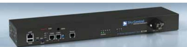
Использование - удаленное по IP выключение, включение и перезагрузка розеток.
